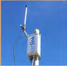
Antena y puerta de enlace de LoRa WAN
