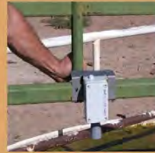
Sensor de DecentLab de nivel de agua en tiempo real habilitado de LoRa
